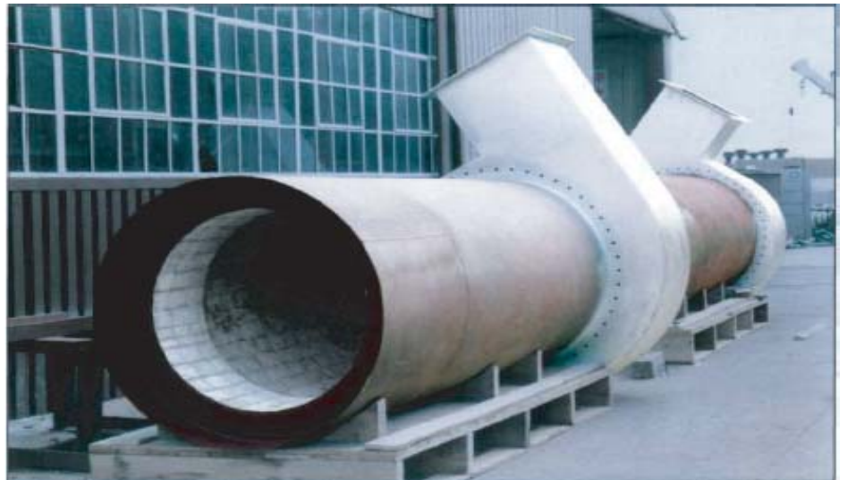
Труба покрыта плиткой (0 1,8 м) для транспортировки рядового угля
