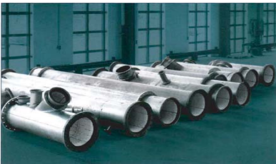
Трубопровод для гидротранспорта рядового угля
